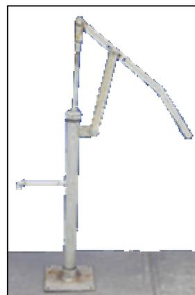
Figura 16 Cabezal de palanca con surtidor fijo.
